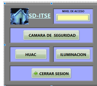
Fig. 9. Panel de control de aplicaciones del sistema.
